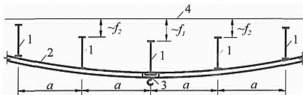
1 - стропильные конструкции; 2 - балка подвесного кранового пути; 3 - подвесной кран; 4 - исходное положение стропильных конструкций;  $f_1$  - прогиб наиболее нагруженной стропильной конструкции;  $f_2$  - прогибы смежных с наиболее нагруженной стропильных конструкций
