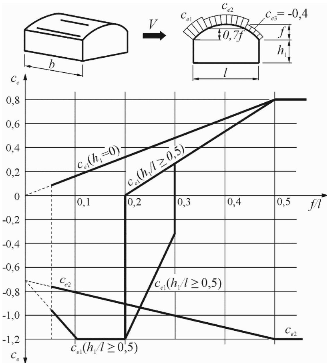
Примечание - При  $0,2 \leq f/l \leq 0,3$  и  $h_1/l \geq 0,5$  необходимо учитывать два значения коэффициента  $c_{e1}$ .
