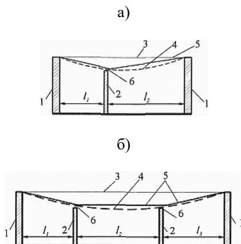
а - одной в пролете; б - двух в пролете; 1 - несущие стены (или колонны); 2 - капитальные перегородки; 3 - перекрытие (покрытие) до приложения нагрузки; 4 - перекрытие (покрытие) после приложения нагрузки; 5 - линии отсчета прогибов; 6 - зазор
