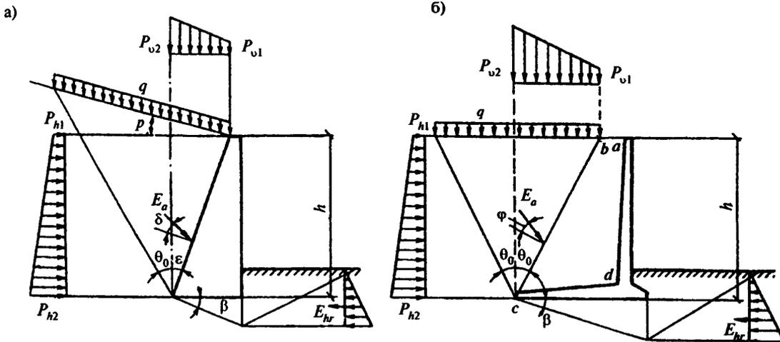
Черт. 1. Расчетные схемы подпорных стен
