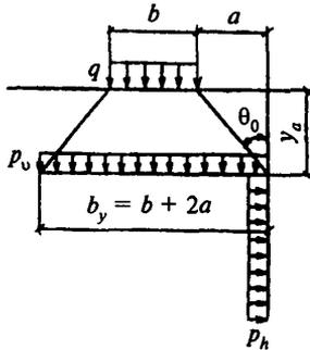
Черт. 2. Схема распределения давления от полосовой нагрузки
