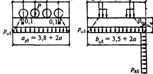
Черт. 5. Схема давления от колесной нагрузки НК-80 при движении ее вдоль сооружения
