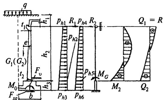
Черт. 3. Расчетная схема стены подвала
