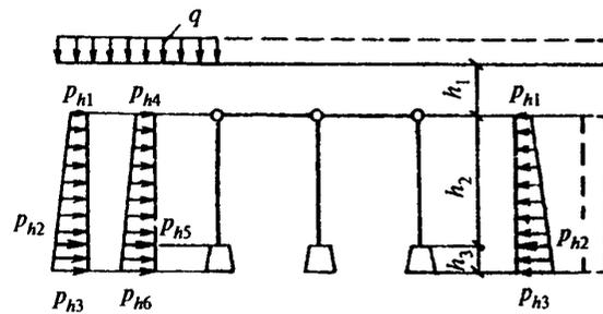
Черт. 2. Расчетная схема поперечной рамы подвала
