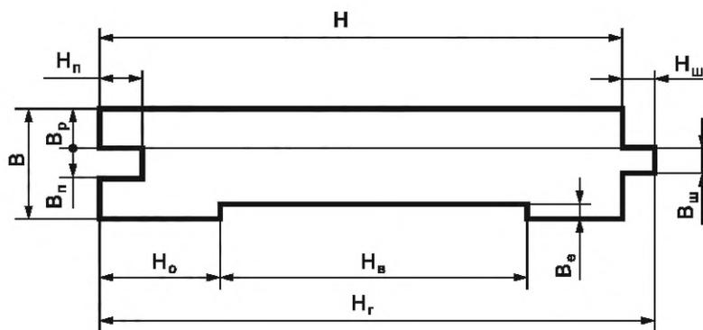
$N$  — ширина изделия покрытия;  $H_g$  — ширина габарита;  $H_b$  — паз в нижней пластине;  $H_o$  — опорная часть нижней пласти;  $H_n$  — глубина паза в кромке;  $H_{ш}$  — ширина гребня на кромке;  $B$  — толщина изделия покрытия из массивной древесины;  $B_{ш}$  — толщина гребня на кромке;  $B_n$  — ширина паза в кромке;  $B_p$  — толщина слоя массива древесины изделия покрытия;  $B_e$  — глубина паза в нижней пласти
