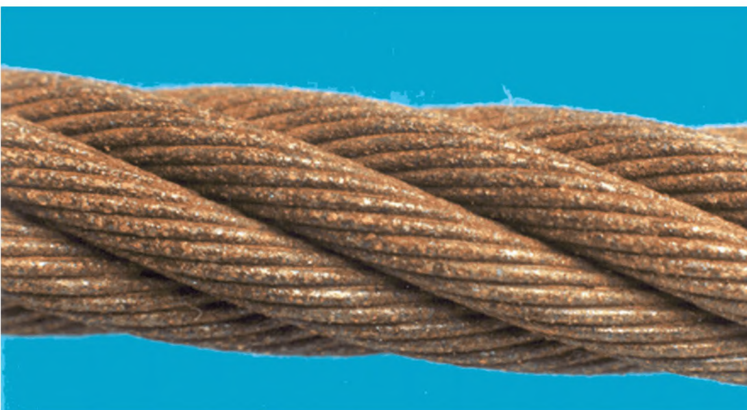
Рисунок А.12 — Наружная коррозия (увеличенный участок каната с рисунка А.11)
