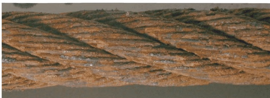
Рисунок Ж.3 — Поверхность проволочек сильно поражена окислением, равномерно по длине каната. Степень повреждения — 60 %
