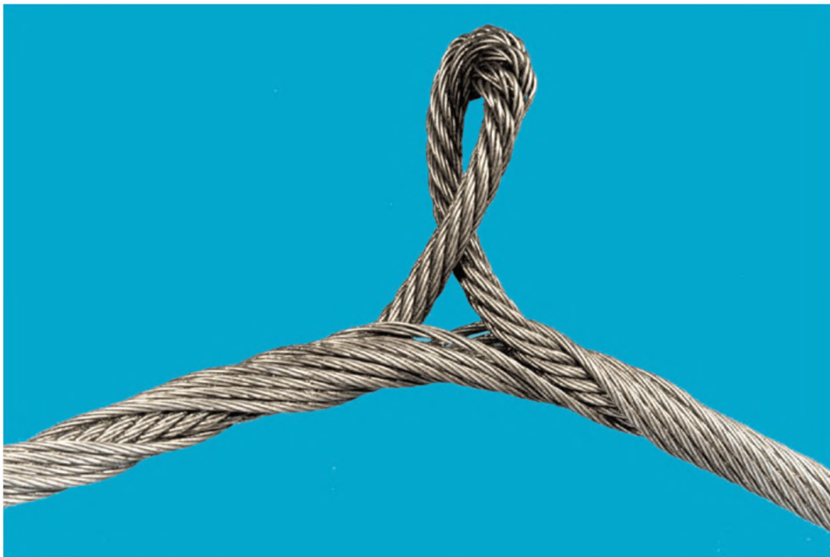
Рисунок А.15 — Некрутящийся канат с выдавленной внутренней частью
