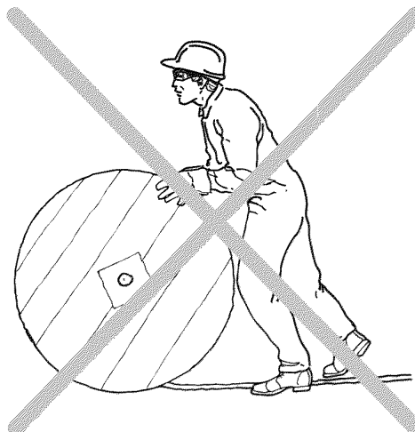
б) Разматывание каната с бобины
