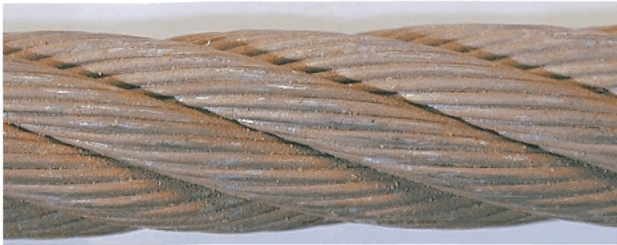
Рисунок Ж.1 — Началo окисления каната (следы коррозии). Коррозию можно удалить протиркой. Степень повреждения — 0 %
