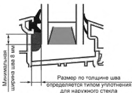
Рисунок 2 — Пример конструкции узла вклейки стеклопакета
